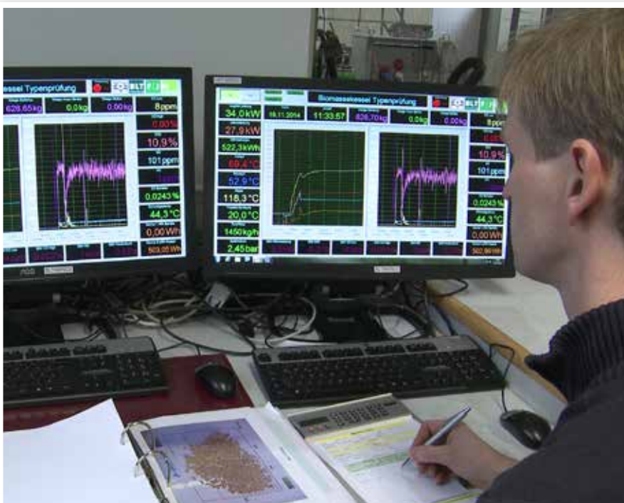
Messdatenanzeige bei der Heizkesselprüfung
