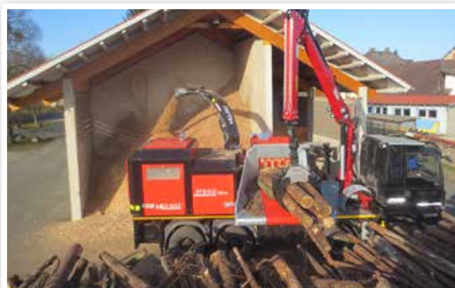
Wood-Terminator 10 XL DS: Der Aufbauhacker erzielt eine Hackleistung von rund 280 srm in der Stunde.
