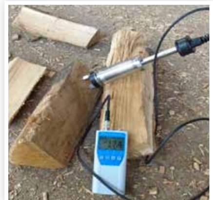
Messung des Wassergehalts von Stückholz
